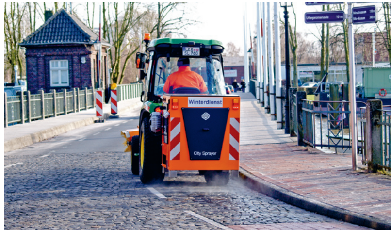
Épandeur à saumure, une technique ménageant le sel. (Photo: EPOKE, City Sprayer)
